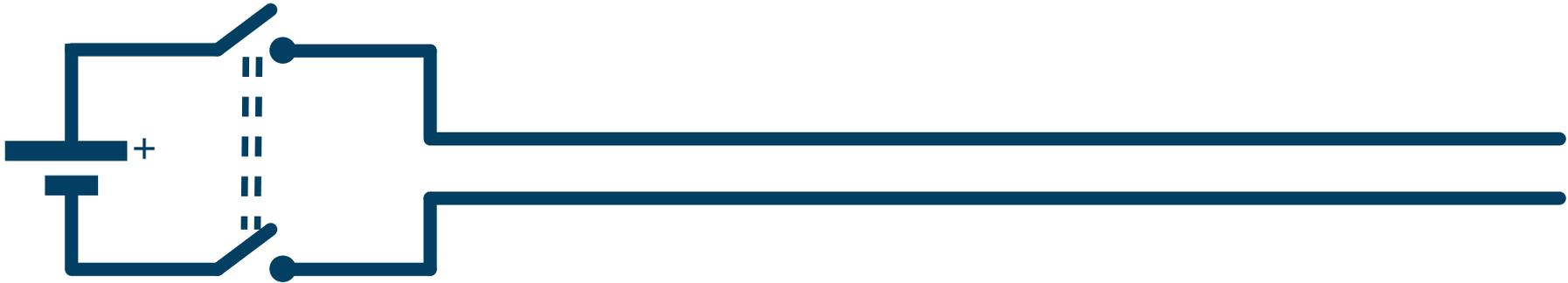
Eine Leitung von z.B. 2,5 m Länge ergibt eine Laufzeit von ca. 10 ns für elektrische Signale (genauer Wert je nach Verzögerungsfaktor der Leitung).
