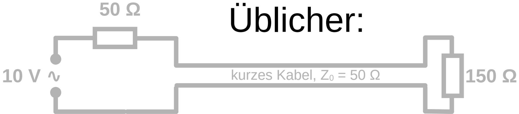
Durch den 150  $\Omega$  Widerstand fließen  $10 \text{ V} / (50 \Omega + 150 \Omega) = 50 \text{ mA}$ .
