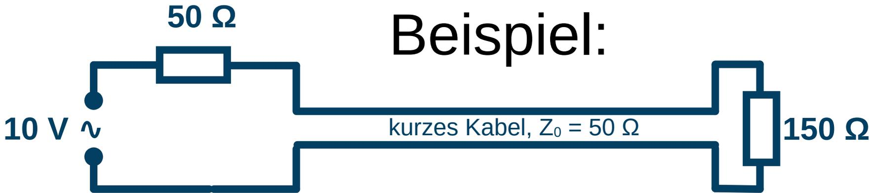
Durch den 150 Ω Widerstand fließen  $10 \text{ V} / (50 \Omega + 150 \Omega) = 50 \text{ mA}$ .
