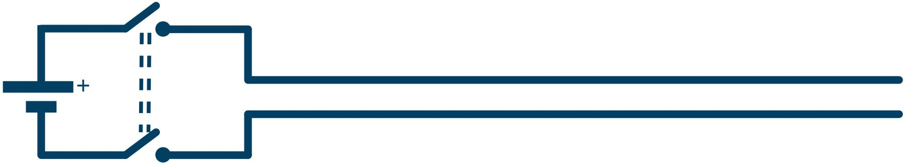
Eine Leitung von z.B. 2,5 m Länge ergibt eine Laufzeit von ca. 10 ns für elektrische Signale
