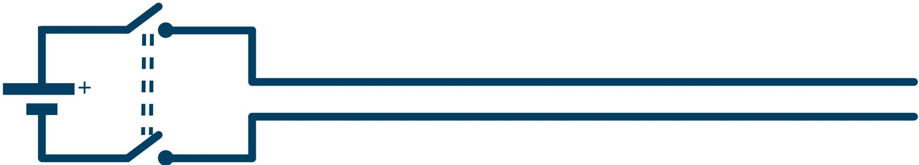
Auch nach dem Schließen des Doppelschalters fließt kein Strom, da der Stromkreis nicht geschlossen ist.
